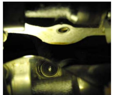
Örv5. Nach Reinigung und Kontrolle des Ventilsitzes, Kugeleinführung mittels Schlauches, danach unter Zuhilfenahme des Spiegels korrekten Sitz der Kugel Überprüfen Fertiger Einbau des Ventils [Siehe Anleitung von Gordon](#)
