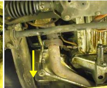
8/3. anschließend das **AUV** nach unten ziehen
