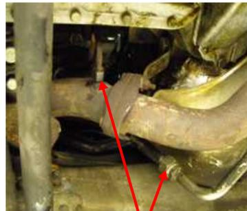
8/1. Die beiden leitungen zum **AUV** aufschrauben.
