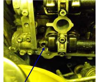
Örv3. Genaue Reinigung des Ventilsitzes und Kontrolle des selben auf Kratzer. Erneuern d. Sitzes wird nicht beschrieben
