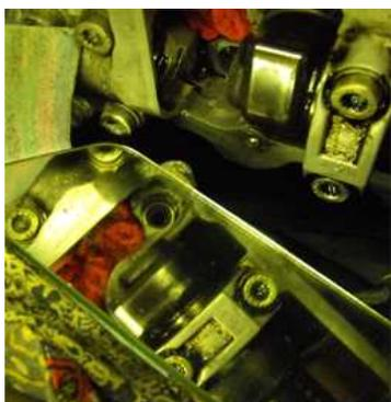
Örv4. mit einem Spiegel kann in den Ventilsitz besser eingesehen werden. Wenn die Kugel auch nur leicht zerkratzt ist - erneuern.
