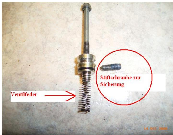
Beim Einsetzen der Madenschraube in den Zylinderkopf unbedingt Sicherungslack oder geeignetes Loctite verwenden
